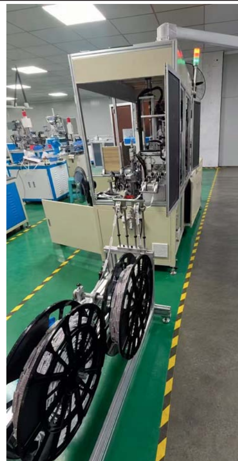
Автоматическая линия по производству модулей UltraSonic — без людей 24 часа.
